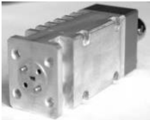
Рис.4.2. Зовнішній вигляд генератора на ЛПД діапазону 90 – 100 ГГц (виробництва НДІ «Оріон»[9])
